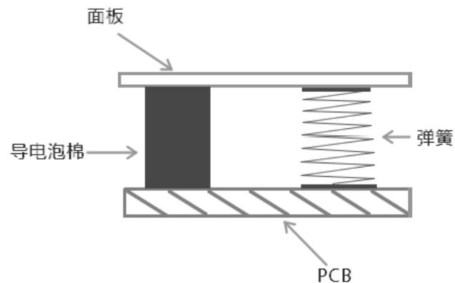
Figure 3-2 泡棉和弹簧做介质设计示例
