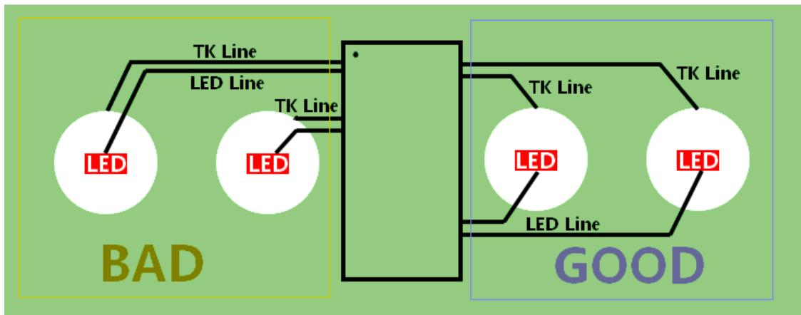
Figure 4-4 LED和TK走线实例
