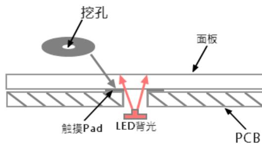
Figure 3-3 触摸焊盘挖孔设计示例
