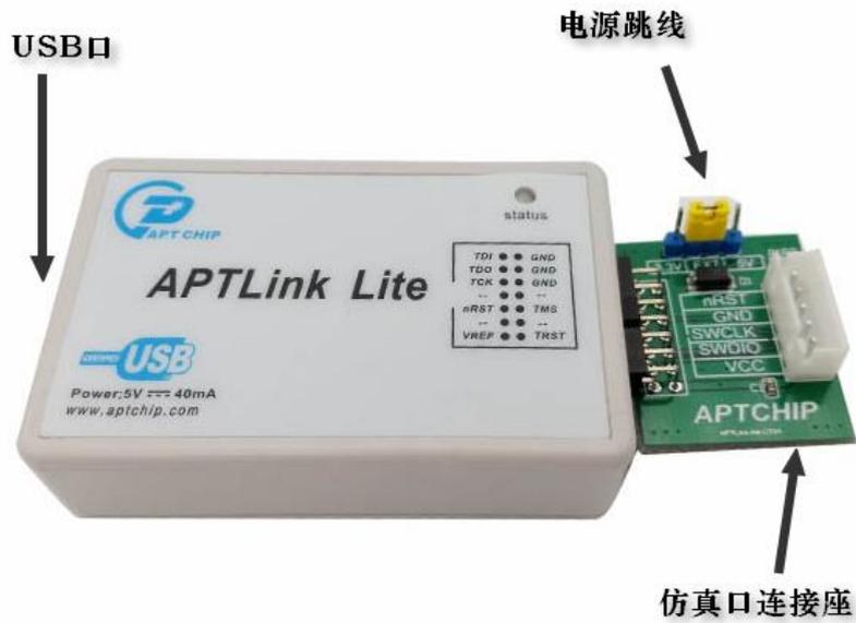
使用 APTlink 进行开发时，需要将目标板上的芯片 VDD/SWCLK/SWDIO/GND 与 APTLink 上对应脚位连接。通过电源跳线可以选择供模式，一共有 3 种供电模式：USB3.3V，USB5V，外部目标板供电。
